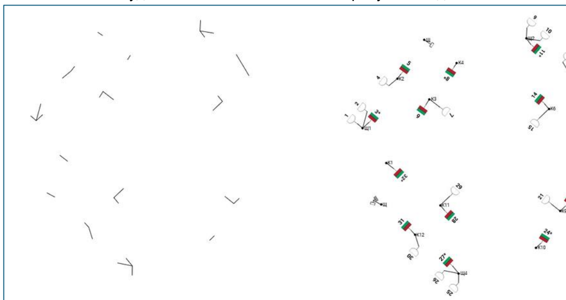
Рисунок 72. Слой Привязка к точке установки. Слева – без опор и светофоров, справа – с опорами и светофорами.
